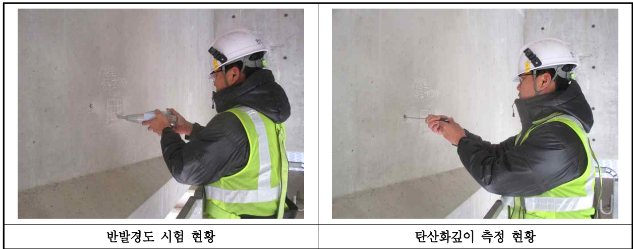
【사진 27.4.1】 콘크리트 내구성조사 현황
